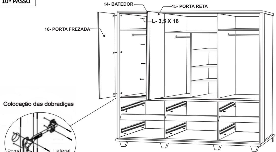
As dobradiças (F) devem ser parafusadas com o parafuso (D) no esquadro para uma boa regulação. O calço com bucha (G) deve ser parafusado com o parafuso que já vem no kit.
